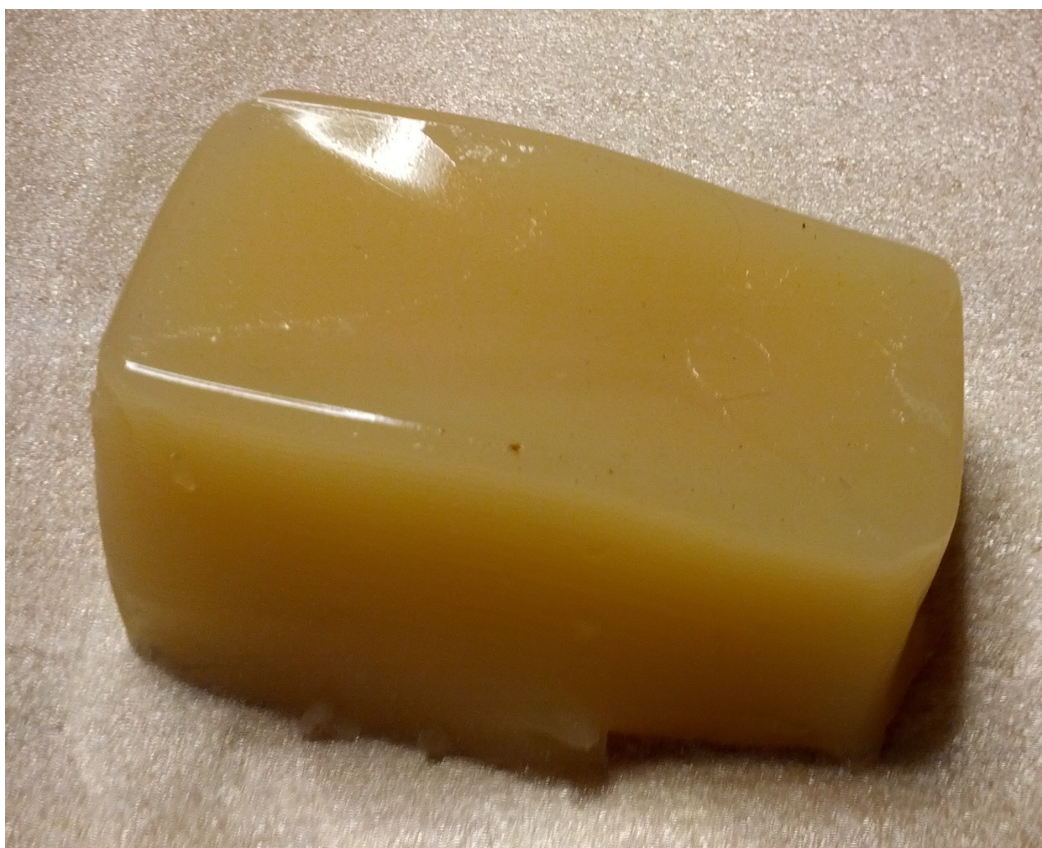
Illustration 64: ½ plade lim opløst i ½ l varmt vand og derefter størknet i køleskab. Limen opvarmes igen når den skal bruges.
