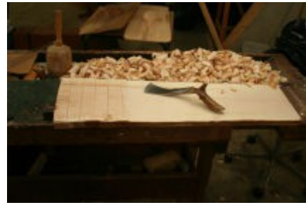
Illustration 29: Næsten afsluttet bearbejdning til 30 mm tykkelse.
