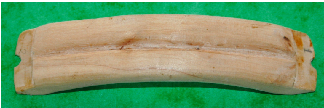
Illustration 38: Det færdige håndtag. Bemærk de to halvrunde indhak i enderne til låsen.
