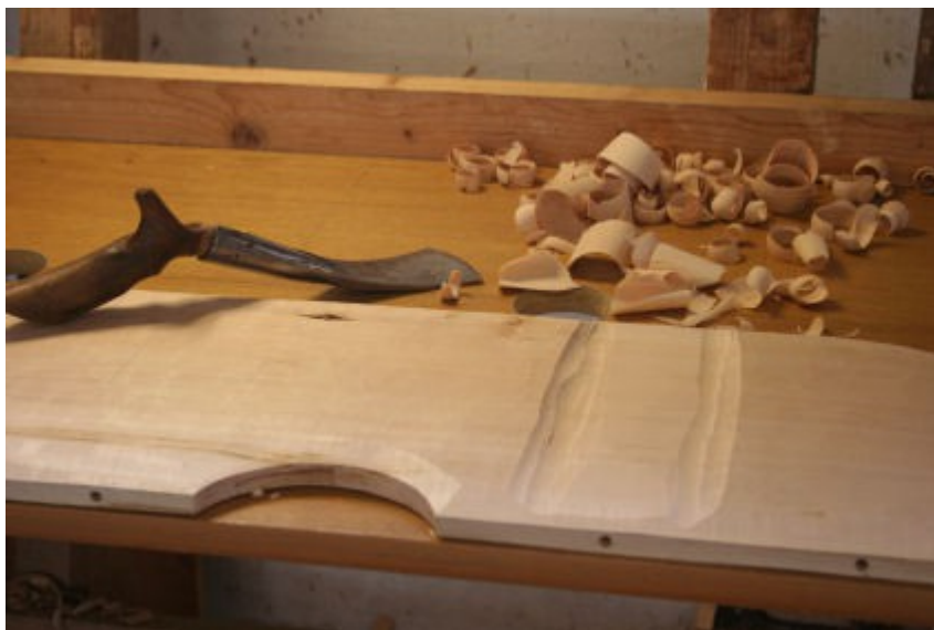
Illustration 32: Bearbejdning til 12 mm på plade uden liste.
